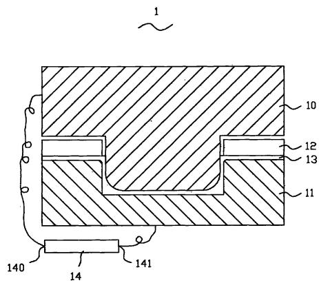
1、一种金属板材冲压装置，至少包括凸模、与凸模相对的凹模，并且凸模的外侧套设有用以将金属板材抵压固定于凹模表面的压边圈，其特征在于该金属板材冲压装置还包括一高能脉冲电源，其两极分别与凸模与凹模电性连接。
