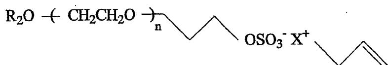
其中R<sub>2</sub>是具有1到20个碳原子，优选10到18个碳原子的烷基，n是2到100，优选2到15的整数，以及X<sup>+</sup>选自<sup>+</sup>NH<sub>3</sub>，<sup>+</sup>NH<sub>2</sub>R<sub>4</sub>或<sup>+</sup>NHR<sub>4</sub>R<sub>5</sub>，其中R<sub>4</sub>和R<sub>5</sub>独立地选自C<sub>1</sub>-C<sub>4</sub>烷基或羟烷基基团。X<sup>+</sup>优选是<sup>+</sup>NH<sub>3</sub>。这一
