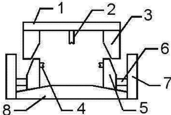
1. 三向冲孔模具，包括刀座、顶刀、压杆、侧刀、压块、弹性部件、固定座、基座，其特征在于刀座中间位置设置有顶刀，压杆为两个，两个压杆分别设置在刀座两侧，侧刀为两把，两把侧刀分别设置在左、右两个压块上，压块通过弹性部件固定在固定座上，压杆下端为斜面，压块上部外侧为斜面，压杆下端的斜面与压块上部外侧的斜面相对应，两个压块呈对称状分别设置在基座上。
