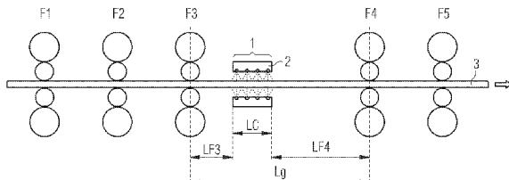
1. 用于在多个相继的轧机机架(F1-F5)中热轧钢带(3)的方法,其中所述钢带首先在奥氏体状态中并且随后在强制的中间机架液体冷却之后在铁素体状态中在一个或者多个轧机机架中精轧到最终厚度,其特征在于,所述钢带(3)的最终厚度小于3mm,特别小于2.5mm,优选小于1.49mm,将所述钢带从液体冷却之前的最后一个轧机机架(F3)出来的出口温度和平衡奥氏体极限温度之间的差通过预控制或者调节所述出口温度来调整到不大于70K,优选不大于50K,优选小于25K,并且两个轧机机架之间的液体冷却根据冷却区段(1)的长度Lc实行,其措施是在所述冷却区段中在钢带(3)的两侧至少各施加液体量 $Qu > 284 / (Lc^{1.42})$ 升每分钟且每米带宽,特别 $Qu > 2 \times 284 / (Lc^{1.42})$ 升每分钟且每米带宽,但是不大于 $Qu = 7 \times 284 / (Lc^{1.42})$ 升每分钟且每米带宽,优选 $Qu < 4 \times 284 / (Lc^{1.42})$ 升每分钟且每米带宽。
