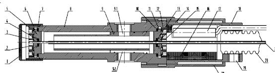
1. 一种用于激光传输的浸泡式水冷光纤头,包括冷却空腔、光纤、导流套,其特征在于:光纤密封在冷却空腔内且穿过导流套,且冷却空腔上设有冷却水进口和冷却水出口,导流套用环氧树脂胶胶连在冷却空腔内壁上,导流套上设的出水口与冷却空腔冷却水出口胶连在一起。
