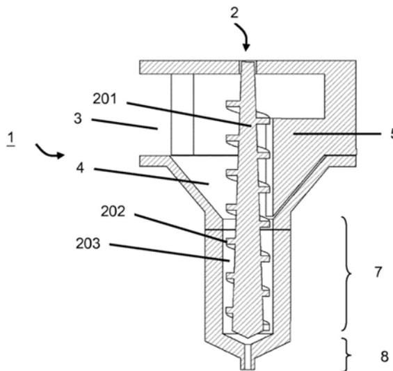
1. 一种用于挤压可热机械地变形的颗粒状的材料(6)的设备,所述设备包括紧凑构型的、竖直设置的螺杆挤出机,所述螺杆挤出机具有1至10、优选1至3的长度/直径比;包括填充装置(3)和挤出机螺杆(2),所述挤出机螺杆与填入漏斗(4)连接;并且包括径向地在所述螺杆挤出机的进入区域中固定或可移动地设置的机构,所述机构缩小了所述填入漏斗(4)中的所述进入区域,
