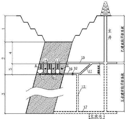
1. 一种露天转地下矿山过渡期井下水患防治方法,将矿山开采阶段分为露天开采阶段(1)、露天转地下过渡阶段(2)、地下开采阶段(3),其特征在于在采用以下技术方案:
