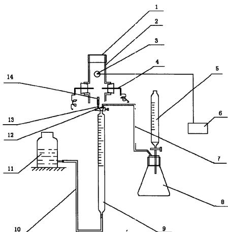
1、一种易燃性气体测定装置，包括气体发生装置和量气管（9），气体发生装置和量气管（9）的进气口（12）间有管道（7）相连通，其特征在于：该装置还包括水准瓶（11），水准瓶（11）和量气管（9）的下部有管道（10）相连通，在量气管（9）顶部的排气口（13）连接有燃烧头（14），燃烧头（14）的上方设置有燃烧罩（2），燃烧头（14）伸入到燃烧罩（2）中，位于其下部的中间位置，在燃烧罩（2）管壁上安置有一对电极（4），电极（4）位于燃烧头（14）的上方。
