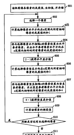
1、一种检测图像灰度变化的方法，其特征在于：该方法预先设置计算水平差分值的第一检测范围和计算竖直差分值的第二检测范围，检测图像灰度变化的过程包括：
