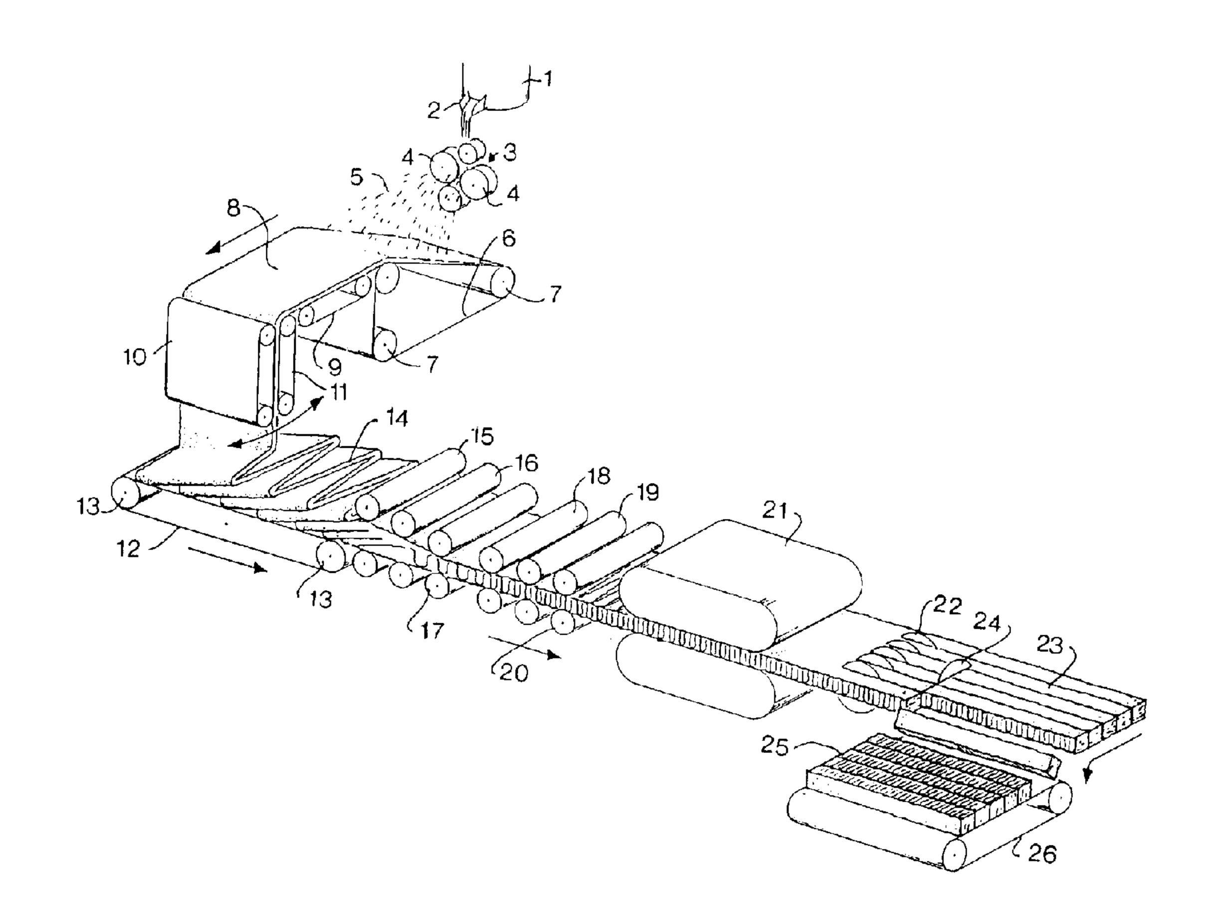
(57) Procédé de fabrication d'éléments de panneau isolant, composés de lamelles de fibres minérales réciproquement reliées, qui consiste à convertir en fibres une masse fondue d'un matériau de départ formant des fibres minérales, à ajouter un produit liant auxdites
