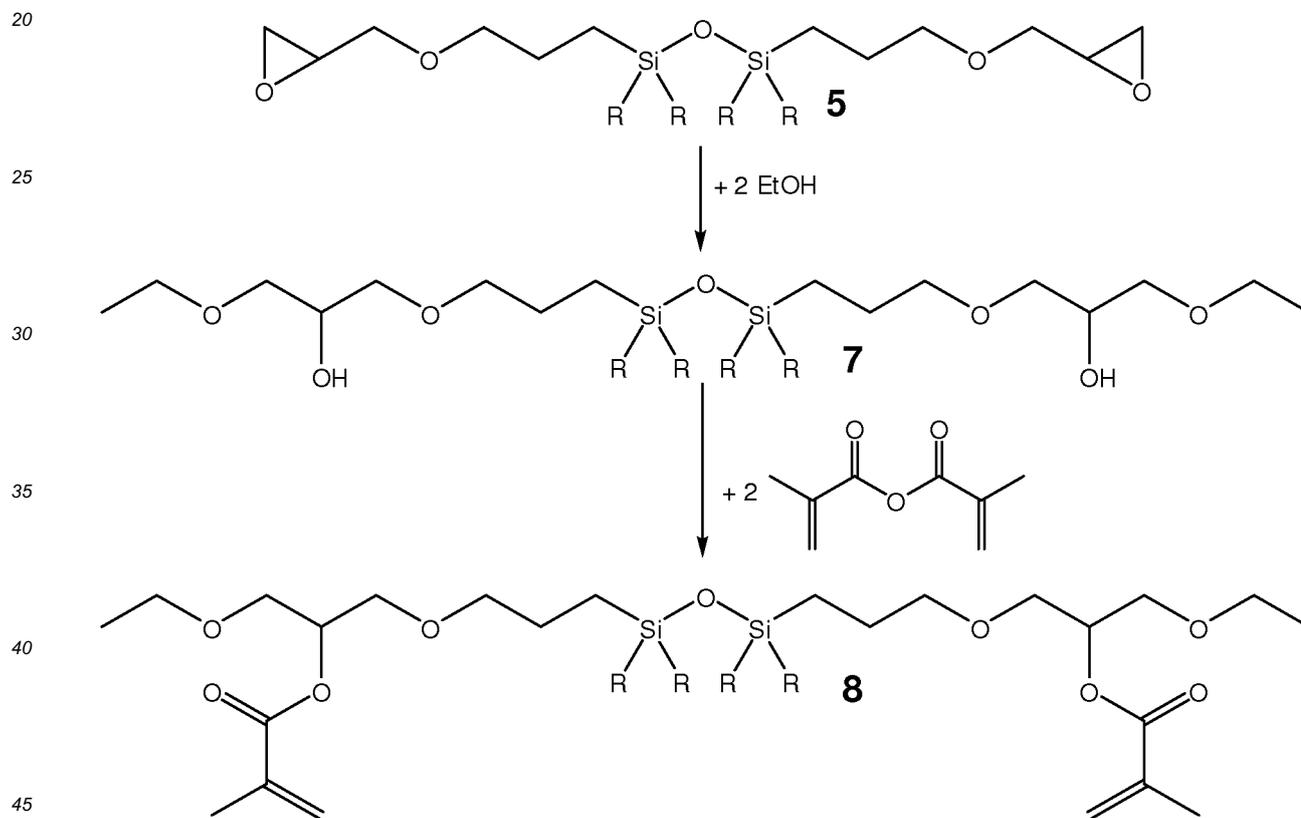
**[0049]** Aus dem 1,3-Bis(3-glycidoxypropyl)disiloxans **5** lässt sich durch Umsetzung mit Ethanol und anschließend Methacrylsäureanhydrid das Disiloxan **8** synthetisieren.
