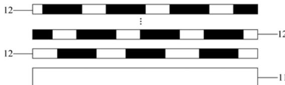
1. 一种显示系统,其特征在于,包括:显示装置以及位于所述显示装置出光侧的三层液晶盒;所述显示装置与所述液晶盒之间以及各层所述液晶盒之间均存在设定间距;
