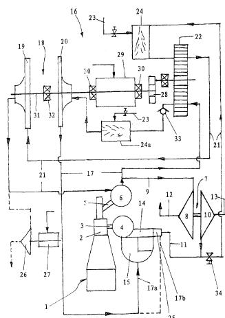
1. 二冲程大型柴油机，它包括至少一个可连接到一增压空气分配管(4)和一排气总管(6)上的气缸(2)、至少一个可利用来自排气总管(6)操作的、压缩可输给增压空气管道(4)的增压空气的废气涡轮增压器(7)和至少一个废气再循环装置(16)，借助该再循环装置使一从离开排气总管(6)的废气中可分流的废气分量可在废气涡轮增压器(7)的下游与增压空气混合，其中设有一压气机(20)，该压气机推动可与增压空气混合的废气分量；其中，废气再循环装置(16)的压气机(20)可借助于一涡轮(19)被驱动，可供给该涡轮(19)以驱动空气，该驱动空气作为空气分量从借助于废气涡轮增压器(7)压缩的增压空气中分流出来，其特征在于：废气再循环装置(16)包括一热交换器(22)，该热交换器一方面可以由可再循环的废气分量流过而另一方面可由构成涡轮(19)的驱动空气的空气分量流过，使得驱动空气在同时冷却可再循环的废气分量的情况下被其加热。
