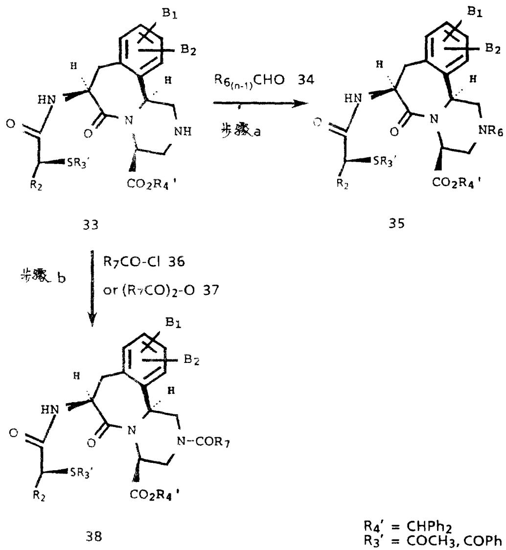
方案 D 提供了 X 为  $-NR_6$  或  $-NCO R_7$  的式 II 化合物的制备的总合成方法。
