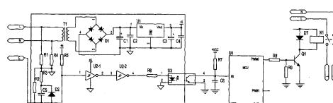
1、一种单片机控制的接地检测保护电路，包括检测电路、保护电路，其特征在于：所述保护电路采用光耦电路与交流电源隔离，检测电路采用三只高阻值 R1、R3、R4 电阻分别与交流电源火线 L、零线 N 和地线 E 构成电压回路，并与检测集成电路输入端连接，检测集成电路的输出端与晶体管 Q1 基极连接，光耦电路输出端与保护电路的单片机输入端连接，单片机输出端与晶体管基极连接，晶体管集电极与火线 L、零线 N 的继电器线圈连接。
