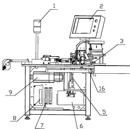
1、全自动环形绕线机，包括机座（3）和安装在机座（3）上的放线器（10）、送线组（11）、绕线组（13）、送料组（14）、直振料斗（15），机座（3）内设有直流电源（6）、机械手和电机驱动器，所述送线组（11）由伺服电机（12）驱动将线由放线器（10）送到绕线组（13），磁环放入可以振动的直振料斗（15）内并由送料组（14）送入夹持座（18），夹持座（18）使磁环位于绕线组（13）的绕线盘（4）内，然后由绕线组（13）的导线气缸（17）驱动导线针将线穿到磁环的孔中，并卷绕到磁环上，其特征是：所述绕线组（13）还设有拉线斜轮组（19），拉线斜轮组（19）包含拉线斜轮、弹簧和可调节悬吊滑块，拉线斜轮可以将线拉紧，弹簧和可调节悬吊滑块可以调节对线夹持力的大小，双股及双股以上的多股绞线经过拉线斜轮组（19），多股绞线的线头在运转过程中不会分叉，绕线组（13）可以将多股绞线卷绕到磁环的不同位置，使多股绞线在磁环上不重叠，还可以连续将多股绞线分别卷绕到不同的磁环上，实现全自动绕线。
