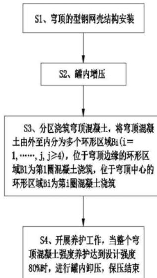
1. 一种LNG储罐外罐穹顶混凝土保压浇筑施工优化方法,其特征在于,包括以下步骤:
