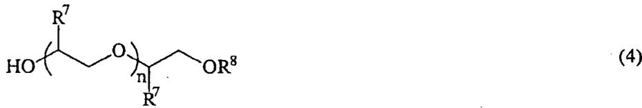
wobei  $\text{R}^7$  jeweils unabhängig voneinander Wasserstoff oder einen Alkylrest mit 1 bis 6 Kohlenstoffatomen bedeutet,  $\text{R}^8$  Wasserstoff darstellt und  $n$  eine Zahl größer gleich 2 ist, C.) mit mindestens einer Verbindung (C) der Formel (5) umgesetzt,
