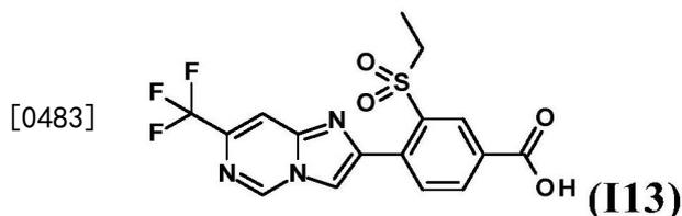
[0484] 向甲基3-乙基磺酰基-4-[7-(三氟甲基)咪唑并[1,2-c]嘧啶-2-基]苯甲酸酯(中间体I12)(800mg,1.94mmol)在干N,N-二甲基甲酰胺(15ml)中的溶液中添加干氯化锂LiCl(410mg,9.68mmol),并将该混合物在微波中于150℃加热1小时。重复地添加更多的LiCl(14x82mg),由此在每次添加之后继续在150℃下加热一小时。将反应混合物用水和乙酸乙酯稀释,分离各相,用0.1N盐酸水溶液将水层酸化至pH 4-5,并用乙酸乙酯充分萃取产物。将合并的有机层经硫酸钠干燥,过滤并浓缩,得到呈固体的粗3-乙基磺酰基-4-[7-(三氟甲基)咪唑并[1,2-c]嘧啶-2-基]苯甲酸(中间体I13)。将该材料进一步在40℃在真空中经五氧化二磷干燥过夜,并且无需进一步纯化即可使用。
