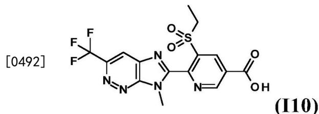
[0493] 将5-乙基磺酰基-6-[7-甲基-3-(三氟甲基)咪唑并[4,5-c]吡嗪-6-基]吡啶-3-甲腈(2.7g, 6.8mmol) 在50%水性硫酸中的溶液(40ml) 在100℃加热2小时。将反应混合物用冰水稀释, 将所得固体过滤, 用冷水洗涤, 并在50℃下在真空中经五氧化二磷干燥过夜, 得到5-乙基磺酰基-6-[7-甲基-3-(三氟甲基)咪唑并[4,5-c]吡嗪-6-基]吡啶-3-甲酸(中间体I10)。LCMS(方法1): 416(M+H)<sup>+</sup>和414(M-H)<sup>-</sup>, 保留时间0.76min。
