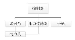
1.一种水平定向钻机的控制方法,其特征在于,设置控制系统,所述控制系统包括控制器、压力传感器、手柄以及比例泵;所述压力传感器包括旋转压力传感器和推拉压力传感器;所述比例泵为电控比例泵,包括旋转泵和推拉泵,所述旋转泵用于驱动动力头的旋转运动,所述推拉泵用于驱动所述动力头的推拉运动;所述手柄为电控手柄,其内设置有滑动电阻,所述滑动电阻与所述控制器电连接,所述手柄包括旋转手柄和推拉手柄,所述控制器被配置的能够检测所述旋转手柄或所述推拉手柄内的滑动电阻是否处于中位位置的电压信号,并根据所述滑动电阻的电压信号和所述水平定向钻机的旋转或推拉压力对所述比例泵的排量进行调节;所述比例泵的排量调节方式均采用是PID比例调节;
