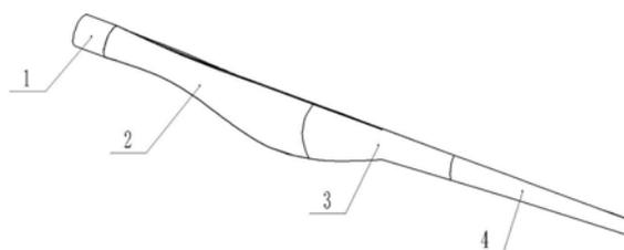
1. 便于运输的风力发电机叶片,其特征在於:包括连接筒和叶片部,所述叶片部的一端与连接筒固定连接;所述叶片部包括叶尾段、叶中段和叶根段,所述叶根段包括一纵截面为圆形的中空腔体,所述中空腔体的内径沿远离连接筒的方向逐渐变小,所述中空腔体的内壁两侧均设有第一收容架,两个第一收容架相对的一侧设有第二收容架;所述叶中段包括下翼部、第一上翼部和第二上翼部,第一上翼部和第二上翼部均呈圆心角小于 $90^{\circ}$ 的弧形,所述第一上翼部和第二上翼部的下端可拆卸连接在下翼部上,第一上翼部的上端与第二上翼部的上端可拆卸连接,第一上翼部和第二上翼部分别放置在两个第一收容架中;所述叶尾段的一端与叶中段可拆卸连接,叶尾段放置在第二收容架上。
