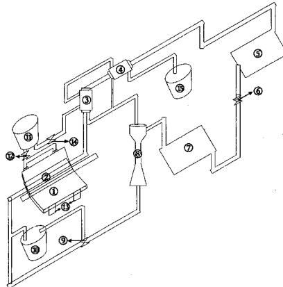
1. 一种太阳能制冷装置,其特征在于:包括由聚焦反射镜加热的内装有制冷剂溶液  $\text{NH}_3 \cdot \text{H}_2\text{O}$  的受热器,受热器出液端依次串接有气液分离器、精馏器、冷凝器、节流阀和蒸发器,蒸发器的气体输出管与喷射器上部相连通,喷射器下端通过三通阀分别与受热器的进液端以及辅助热源进液端连通,辅助热源出液端与受热器进液端连通,喷射器上端通过进液管分别与分离器和精馏器连通,精馏器上连接有通入蓄热桶的进水管,装置中还包括储水桶和聚焦反射镜调节机构,储水桶通过相应管路、阀门分别与聚焦反射镜调节机构以及分离器、精馏器、蓄热桶连通。
