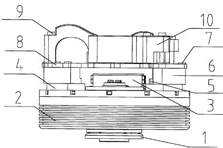
1、一种电动汽车轮毂电机集成结构，它包括有一轮毂电机，电机接线盒，其特征是：在轮毂电机的下部固定连接有一与轮辋连接在一起的转接法兰盘；在轮毂电机上部的端盖上配装有一便于连接的轮毂电机端盖凸台，在该轮毂电机端盖凸台的上部依次通过螺栓连接有凸台过渡连接板、支架过渡连接板及轮毂电机支架，该支架过渡连接板的上部则与刹车盘螺栓连接。
