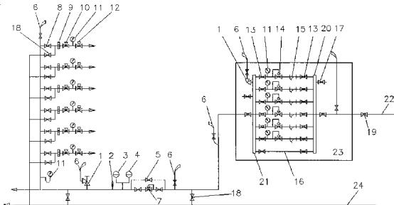
1. 一种使用天然气进行煤粉锅炉点火和稳燃系统,包括与天然气供气管(22)连通的锅炉点火系统,其特征在于:天然气供气管与锅炉点火系统之间设置有调压站(23),在调压站(23)之前的天然气供气管(22)上安装有气源总切断阀(19);调压站(23)依次由分气缸(20)、多路并行调压管路和集气缸(21)连接而成,集气缸(21)上伸出母管进入锅炉房,母管上引出管路连通各个煤粉燃烧器位置上的天然气喷枪;所述喷枪前按流向依次设有手动切断阀(8)、流量计(9)、流量调节阀(10)、压力表(11)、安全切断电磁阀(12)。
