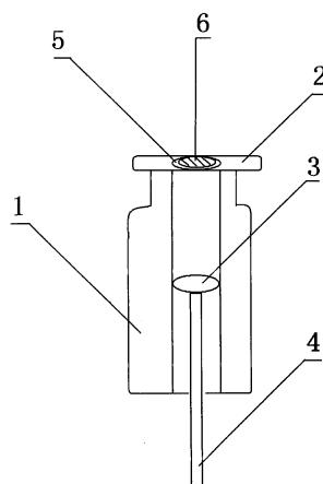
1、新型服药装置，包括瓶体（1）和瓶盖（2），其特征是：在瓶体（1）内设有活塞（3），活塞（3）上设有推杆（4），瓶盖（2）上设有出药孔（5），出药孔（5）由孔塞（6）密封。
