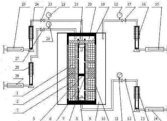
1. 一种分层压裂层间窜流模拟实验装置,其特征在于:这种分层压裂层间窜流模拟测定装置的中心套管(7)分隔成上下两个腔体,中心套管(7)外环绕着围压室,在中心套管(7)和分层压裂岩体中间环空胶结有水泥环(6);围压室内装有分层压裂岩体,分层压裂岩体由上层砂岩岩体(1)、中间泥页岩隔层(2)和下层砂岩岩体(3)构成;围压室上面是上覆外载加压室(20),中心套管(7)伸入上覆外载加压室(20)中,围压室的外壁是夹持胶筒(10),围压室外环绕着侧向加压室(9)。
