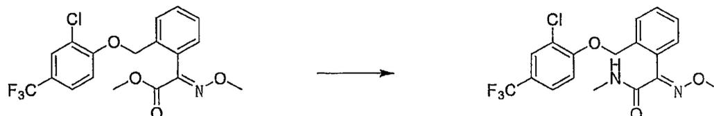
[0074] 将 0.60 克化合物 4 与两倍摩尔比的甲胺水溶液在 50 毫升四氢呋喃中室温搅拌过夜,浓缩后用乙酸乙酯萃取 2 次,合并的提取物用水洗涤 3 次,再用饱和食盐水洗 2 次,干燥,过滤,浓缩,得标题化合物 0.53 克,熔点 92-94℃。收率 88.5%。
