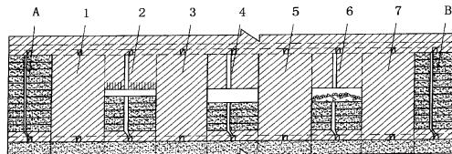
1、一种盘区端部卸荷的分层充填采矿方法，包括在采矿盘区两端分别布置一个垂直矿体走向的立槽采场（A、B），在两立槽采场之间布置多个垂直矿体走向的盘区采场（1-7），立槽采场（A、B）及盘区采场（1-7）均采用上向分层充填采矿法回采，立槽采场（A、B）超前盘区采场（1-7）回采及充填，以隔断水平应力向盘区采场的传递。
