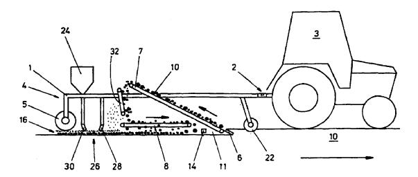
(57) L'invention concerne une machine pour la préparation des sols. Cette machine comprend un moyen de levage du sol (6, 7) pour soulever une couche du sol, un moyen de rupture du sol (8) pour briser la couche du sol, et un châssis (1) auquel sont fixés le moyen de levage du sol (6, 7) et le moyen de rupture du sol (8).
