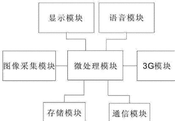
1. 一种基于人脸识别的门禁控制系统,其特征在于,包括人脸图像采集模块、微处理器模块、通信模块、后台控制计算机、门禁控制器,人脸图像采集模块将采集到的人脸图像传输至微处理器模块,经处理后通过通信模块将该处理后的人脸图像传输至后台控制计算机,后台控制计算机将该人脸图像与系统数据库中人脸图像进行比对,若采集到的人脸图像存在于上述系统数据库中,则发出一控制信号至门禁控制器去执行开门动作。
