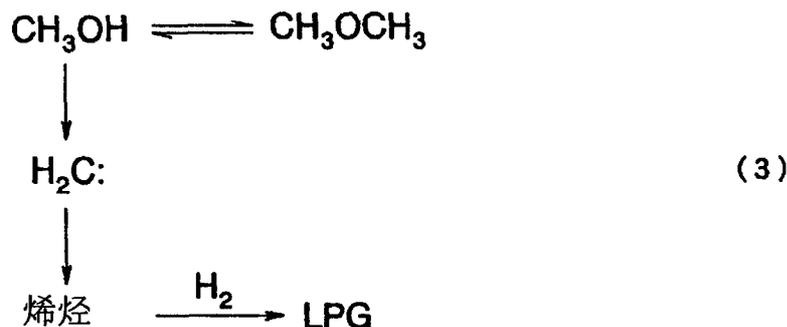
[0164] 本发明中, 根据沸石细孔内空间场中配座的酸点和盐基点的协同作用, 甲醇脱水生成碳烯 ( $\text{H}_2\text{C:}$ ), 碳烯聚合生成主要成分为丙烯或丁烯的烯烃。具体为: 碳烯作为二聚体生成乙烯, 作为三聚体或与乙烯反应生成丙烯, 作为四聚体或与丙烯反应生成丁烯。乙烯的二聚化也可生成丁烯。
