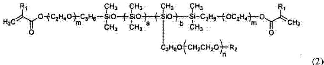
[0262] 其中式 (2) 中的 R<sub>1</sub> 选自氢原子或甲基；式 (2) 中的 R<sub>2</sub> 选自氢原子或具有 1 到 4 个碳原子的烃基；式 (2) 中的 m 代表 0 到 10 的整数；式 (2) 中的 n 代表 4 到 100 的整数；a 和 b 代表 1 或更大的整数；a+b 等于 20 到 500；b/(a+b) 等于 0.01 到 0.22；硅氧烷单元的构型包括无规构型；且所述第二硅氧烷单体具有至少 3,000 道尔顿的数量平均分子量。第一硅氧烷单体和第二硅氧烷单体基于单位份数以至少 2 : 1 的比率存在于可聚合组合物中。可聚合组合物还包含至少一种亲水单体、或至少一种疏水单体、或至少一种交联剂或其任一组合。
