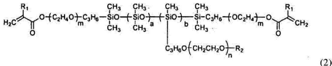
[0219] 其中式 (2) 中的  $R_1$  选自氢原子或甲基；式 (2) 中的  $R_2$  选自氢原子或具有 1 到 4 个碳原子的烃基；式 (2) 中的  $m$  代表 0 到 10 的整数；式 (2) 中的  $n$  代表 4 到 100 的整数； $a$  和  $b$  代表 1 或更大的整数； $a+b$  等于 20 到 500； $b/(a+b)$  等于 0.01 到 0.22；硅氧烷单元的构型包括无规构型；且所述第二硅氧烷单体具有至少 3,000 道尔顿的数量平均分子量；和具有一个 N- 乙烯基的亲水酰胺单体或单体组份，其中第一硅氧烷单体和第二硅氧烷单体是基于单位重量份数以 2 : 1 的比率存在于组合物中。特定地，亲水单体可包含 N- 乙烯基 -N- 甲基乙酰胺 (VMA) 或由其组成。
