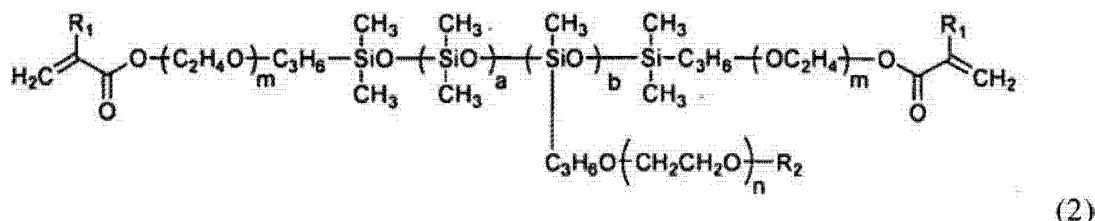
[0271] 其中式 (2) 中的  $R_1$  选自氢原子或甲基; 式 (2) 中的  $R_2$  选自氢或具有 1 到 4 个碳原子的烃基; 式 (2) 中的  $m$  代表 0 到 10 的整数; 式 (2) 中的  $n$  代表 4 到 100 的整数;  $a$  和  $b$  代表 1 或更大的整数;  $a+b$  等于 20 到 500;  $b/(a+b)$  等于 0.01 到 0.22; 且硅氧烷单元的构型包括无规构型。作为一个实例, 第二硅氧烷单体可由式 (2) 代表, 其中式 (2) 中的  $m$  为 0, 式 (2) 中的  $n$  是一个 5 到 15 的整数,  $a$  是一个 65 到 90 的整数,  $b$  是一个 1 到 10 的整数, 式 (2) 中的  $R_1$  是甲基, 且式 (2) 中的  $R_2$  是氢原子或具有 1 到 4 个碳原子的烃基。
