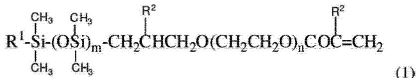
[0259] 其中式 (1) 中的 m 代表一个 3 到 10 的整数，式 (1) 中的 n 代表一个 1 到 10 的整数，式 (1) 中的 R<sup>1</sup> 是具有 1 到 4 个碳原子的烷基，且式 (1) 中的每一 R<sup>2</sup> 独立地为氢原子或甲基。可聚合组合物还包含
