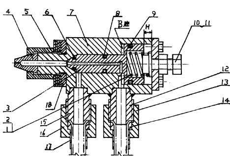
1、一种喷嘴装置，包括喷嘴体(7)，喷嘴体(7)通过螺母(5)及垫片、喷嘴联接板(18)接有喷嘴(4)，喷嘴体(7)上开有两孔，一孔通过扩口式焊接接头体(12)、扩口式焊接接头螺母(13)接压缩空气套管(14)，另一孔通过扩口式焊接接头体(15)、扩口式焊接接头螺母(16)接压力油套管(17)，其特征在于喷嘴体(7)内有可在喷嘴体(7)内活动的活塞(3)，喷嘴体(7)内表面与活塞(3)外表面有O形密封圈(6)、(8)、(9)滑动密封，活塞(3)的压缩空气的进入端有供压缩空气进入的孔，活塞(3)内有通道，压缩空气进入活塞(3)内经活塞(3)内的通道从活塞(3)另一端再经喷嘴体(7)和喷嘴(4)喷出，活塞(3)的压力油进入端为锥体形；喷嘴体(7)上还有孔，螺栓(10)穿过该孔，通过螺栓(10)、螺母(11)调节弹簧(1)和弹簧座(2)，弹簧(1)的另一头顶住活塞(3)。
