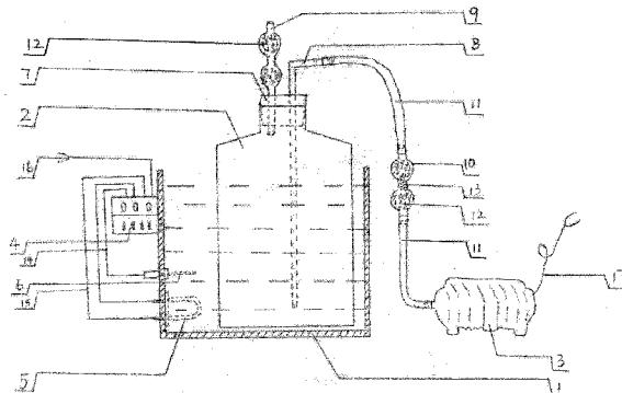
1. 一种液体菌种深层培养简易发酵装置,其特征在于:该装置的结构主要是由恒温池(1)、培养瓶(2)、气泵(3)组成;其中,恒温池(1)装有清水,而培养瓶(2)是安置在恒温池(1);恒温池(1)是由温控仪表(4)、加热管(5)、温度探头(6)组成,加热管(5)和温度探头(6)都是安置在恒温池(1)内,而且都是连接着温控仪表(4);培养瓶(2)是由瓶塞(7)、进气管(8)、培养瓶过滤器(9)组成,进气管(8)和培养瓶过滤器(9)都是穿透并安置于瓶塞(7)中,瓶塞(7)安置于培养瓶(2)的瓶口中;气泵(3)是通过管道过滤器(10)和胶管(11)与进气管(8)连接在一起;培养瓶过滤器(9)里面放置有棉花(12),管道过滤器(10)里面放置有棉花(12)和活性炭(13)。
