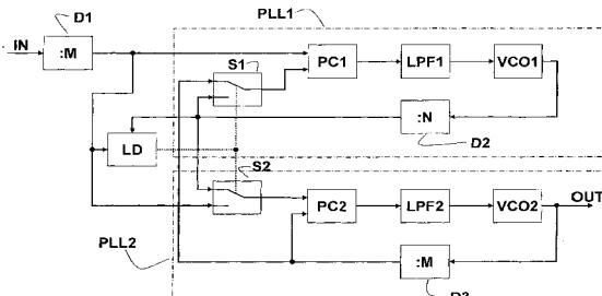
1. 一种电子电路，具有：包括第一相位比较器 (PC1) 和第一可控振荡器 (VC01) 的第一 PLL 电路 (PLL1)、包括第二相位比较器 (PC2) 和第二可控振荡器 (VC02) 的第二 PLL 电路 (PLL2)，其中输入信号 (IN) 连接到第一 PLL 电路 (PLL1) 的第一相位比较器 (PC1) 的输入，其中提供第二开关 (S2)，用于选择性地连接输入信号 (IN) 或第一 PLL 电路 (PLL1) 的输出信号到第二 PLL 电路 (PLL2) 的第二相位比较器 (PC2) 的输入，其特征在于，提供第一开关 (S1)，用于选择性地连接第一 PLL 电路 (PLL1) 的输出信号或第二 PLL 电路 (PLL2) 的输出信号到第一 PLL 电路 (PLL1) 的相位比较器的另一输入作为反馈信号源，并且第二 PLL 电路 (PLL2) 的输出是该电子电路的唯一输出，
