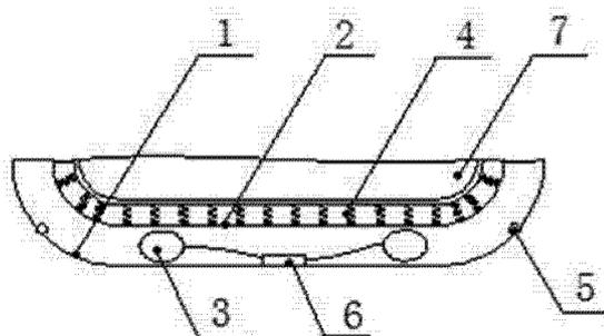
1. 一种汽车柔性保护装置,其特征在于:包括与车头形状吻合的前缓冲板(1)和后缓冲板(2),在前缓冲板(1)和后缓冲板(2)之间设置有安全气囊(3),前缓冲板(1)的两端设置有滚动保护杠(5),后缓冲板(2)通过弹簧装置(4)安装在车体(7)的前部。
