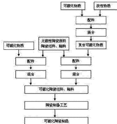
1. 一种可磁化陶瓷的制备方法,它是在非磁性陶瓷粉料中掺入可磁化物质,采用陶瓷制备工艺,制备可磁化的陶瓷制品,其特征在于,它包括如下步骤:
