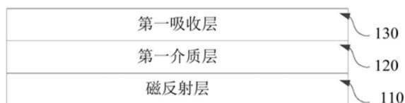
1. 一种磁性颜料片,其特征在於,所述磁性颜料片包括磁反射层以及依次层叠设置于所述磁反射层的第一主表面上的第一介质层和第一吸收层,其中,所述磁反射层包括至少一种磁性材料;
