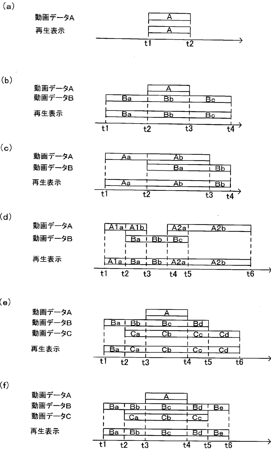
【図7】 切替表示モードの長時間動画優先モードにおける組合せ表示モード
