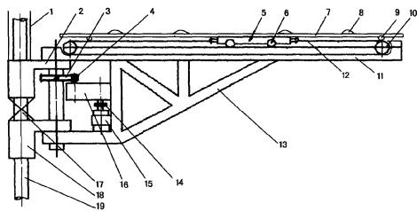
1. 一种立体车库摇臂式升降装置，它包括一根立柱（19）和套连在立柱上的上升降臂（2）和下升降臂（18），其特征在于：在所述的上升降臂（2）和下升降臂（18）上铰接有一个承载车辆的动摆动装置，上升降臂（2）通过钢索（1）与升降定位系统连接，在所述的上升降臂（2）和下升降臂（18）之间有一个升降定位后的自锁装置（17），所述摆动装置、升降定位系统以及自锁装置都与计算机控制系统连接。
