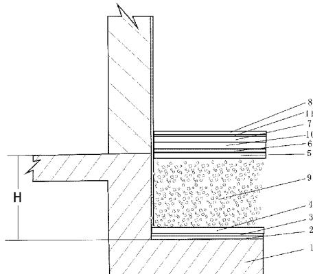
1. 一种降板式同层排水的建筑结构,它包括基层和顶层,所述基层包括混凝土楼板(1)、依次在混凝土楼板(1)上的基层找平层(2)、基层防水层(3)和基层水泥砂浆保护层(4),所述顶层自下而上依次包括顶层找平层(5)、顶层防水层(6)、水泥砂浆结合层(7)和装饰面层(8);所述基层与顶层之间还设有填充物(9),其特征在于所述降板高度H≤250毫米,所述顶层防水层(6)与水泥砂浆结合层(7)之间设有顶层水泥砂浆保护层(10)。
