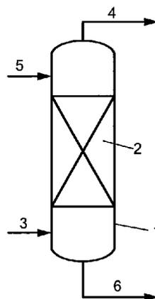
1. 一种脱除汽油中硫醇硫的方法,其特征在于原料由反应器上部引入,由上而下流过反应器,在反应温度为  $150 \sim 350^{\circ}\text{C}$ ,压力为  $0.2 \sim 6\text{MPa}$ ,进料液时体积空速为  $2 \sim 15\text{h}^{-1}$ ,进料气油体积比为  $5 \sim 200$  的条件下和反应器中装填的脱硫醇催化剂接触,原料中的硫醇分解为烯烃和硫化氢气体,反应器底部引入汽提介质,汽提介质与汽油逆流接触,将生成的硫化氢气体及时移出反应区,含有硫化氢的汽提介质由反应器上部排出,反应器底部引出脱除了硫醇的汽油产品,所述的汽提介质为惰性气体和 / 或蒸汽;所述的脱硫醇催化剂为负载在氧化铝或硅铝载体上的 VIB 和 / 或 VIII 族非贵金属催化剂。
