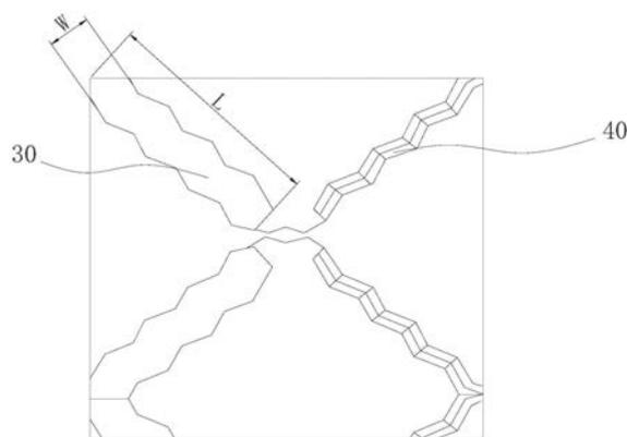
1. 一种触控层组,其特征在於,所述触控层组包括衬底层及形成於所述衬底层的多个第一触控电极与多个第二触控电极,所述多个第一触控电极与所述多个第二触控电极相互交错;
