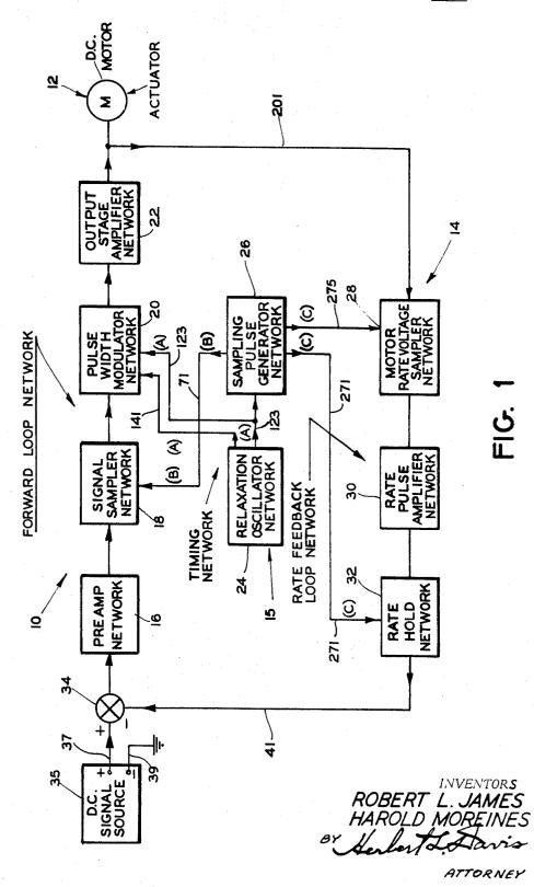
PULSE WIDTH MODULATED SERVO DRIVE CONTROL SYSTEM
