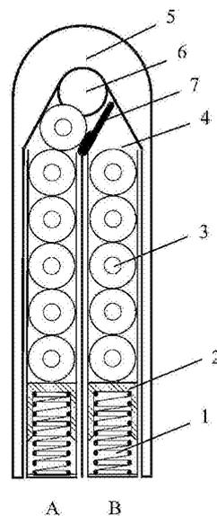
1. 一种枪械多弹匣连续发射系统,其特征在于:枪械配置有两个或以上的弹匣,各个弹匣之间是相对独立的,各个弹匣均可以安装在枪身上也可以从枪身上拆卸下来;每个弹匣的底部均设置有压力弹簧,压力弹簧的顶部安装有弹托,子弹从下往上依次排放在弹托上,每个弹匣的顶部为供弹出口;当各个弹匣安装在枪身上时,各个弹匣的供弹出口均与枪身内的上膛装置的供弹入口形成通道;在弹匣与上膛装置之间安装有导向/抓取机构,导向/抓取机构可以进行切换动作,以选择性地连通上膛装置与其中一个弹匣之间的通道,同时封闭上膛装置与其余弹匣之间的通道;或者选择性地抓取其中一个弹匣的子弹。
