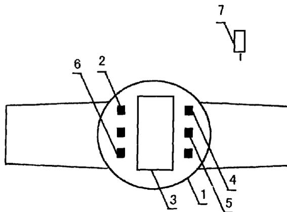
1. 游泳者手机来电提示装置,其特征在于包括一个腕表状外壳 [1],内置远程通讯模块 [2]、显示模块 [3]、控制按钮 [4]、提示装置 [5],远程通讯模块 [2] 与事主手机 [7] 设定链接,当手机有信号接收时,区分短信与来电,如为短信则转发显示在显示模块 [3] 显示,如果为来电即在显示模块 [3] 显示号码,提示装置 [5] 发出提示信息。
