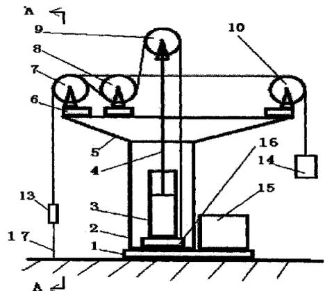
1、一种塔式液压长冲程抽油机，其整体结构包括六大部分：底座（1），机架（2），包括缸筒（3）及活塞杆（4）的伸缩油缸、机头（5），液压站（15），外加电器控制部分；底座（1）固定于地面；机架（2）与液压站（15）安装于底座（1）的上方；其特征在于：伸缩油缸的缸筒（3）安装于机架（2）内部、底座（1）上面；伸缩油缸的活塞杆（4）从伸缩油缸的缸筒（3）的上面伸出；动滑轮（9）固定于伸缩油缸的活塞杆（4）的上方；机头（5）安装于（2）机架的上方，其前后相对于机架（2）伸出，成悬臂梁状；机头（5）上面中部固定安装有中滑轮（8）、远离油井的一端安装有滑轮组（10）；横梁（6）以活动连接方式安装于机头（5）的上方、近油井一端，松开活动连接后，可以向机架（2）方向缩回；前滑轮组（7）固定在横梁（6）上；钢丝绳（11）的近油井端绕过前滑轮组（7）垂下，连接在与抽油杆（17）相连的牛轭（13）上面，另一端绕过后滑轮组（10）垂下，连接在配重篮（14）上；钢丝绳（12）的近油井端绕过前滑轮组（7）垂下，连接在牛轭（13）上面，另一端先绕过中滑轮（8），然后绕过动滑轮（9）垂下，固定在底座（1）上。
