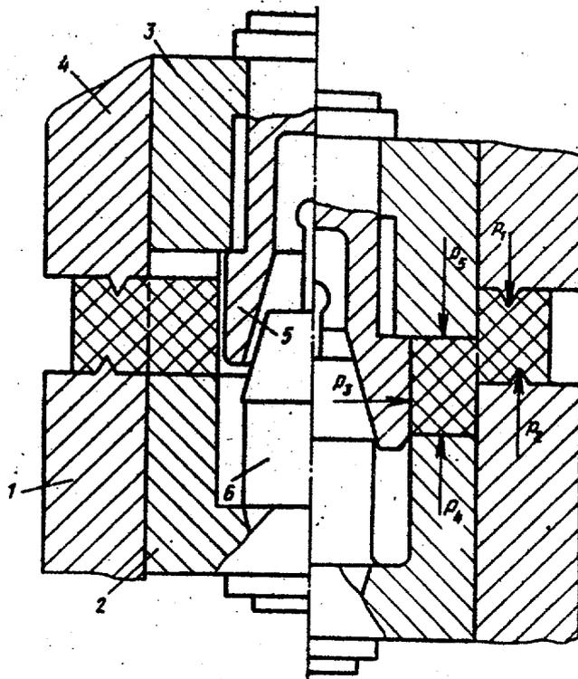
Изобретение относится к технологической оснастке для обработки давлением, в частности для чистовой выруб- ки деталей из заготовок, имеющих от- 5 верстия, и может использоваться при вырубке деталей типа колец упорных подшипников.
