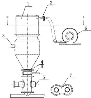
1. 一种粉体吸送料装置,其特征在于包含袋滤桶(1)、引风口(2)、吸入口(3)、出料口(4)、给料机(5),袋滤桶上设有引风口、吸入口、出料口,给料机设置在出料口的下方。
