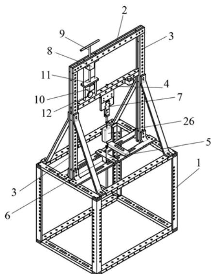
1. 一种光敏树脂模型加载装置，包括拉伸加载单元和压力加载单元，所述拉伸加载单元用于拉伸光敏树脂模型并测量拉伸的拉力，所述压力加载单元用于对光敏树脂模型加压并测量加压的压力，其特征在于，所述光敏树脂模型加载装置包括：
